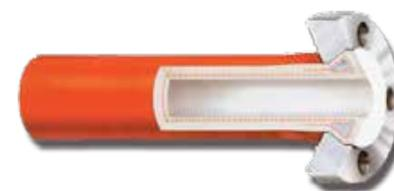
Tallone in gomma a sezione trapezoidale rinforzato da un anello metallico; flangia mobile intera o scomponibile in due metà riutilizzabile al momento della sostituzione del tubo
